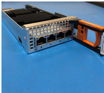
Figure 34. 10 GbE BASE-T I/O module
